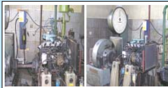
Gambar 1c Bangku Uji Isuzu 4JA1
