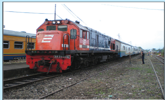
Gambar 3 Lokomotif Diesel BB 203 berhidung pendek (Sumber: Wikipedia)
