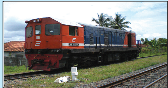
Gambar 2 Lokomotif Diesel BB 202 03 tampak cabin masinis lebih sempit (Sumber: Wikipedia)
