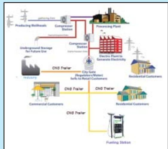
Gambar 2 Moda Transportasi CNG dari Sumber Gas ke Konsumen
