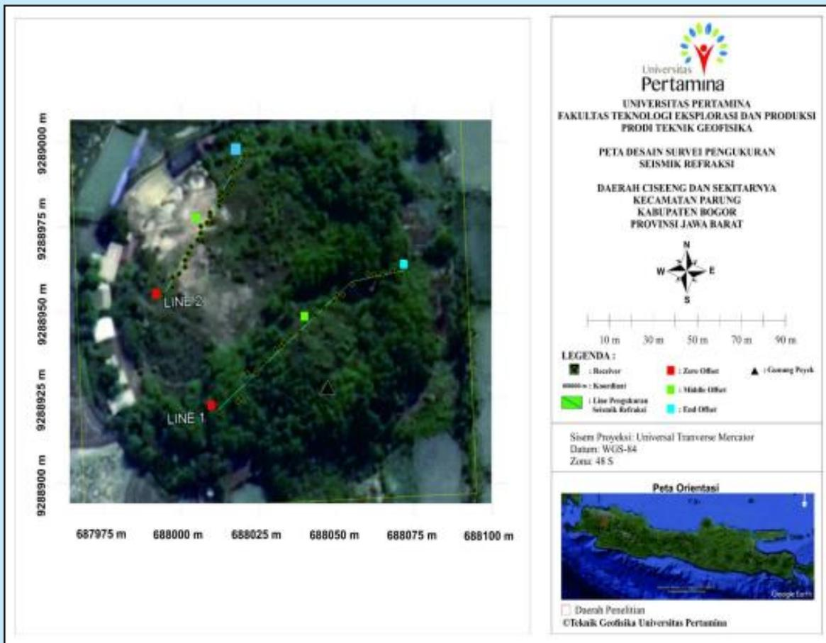
Gambar 5 Desain survei pengukuran seismik refraksi.
