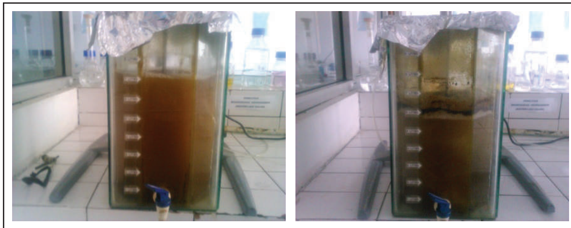
Gambar 2 Uji biodegradasi minyak pada media SWNB dan media control pada hari ke-7.
