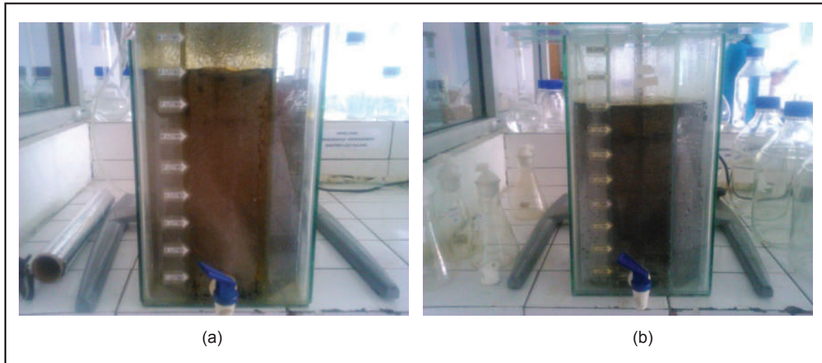
Gambar 1 Uji biodegrasi minyak pada media SWNB dan media kontrol pada hari ke-0.
