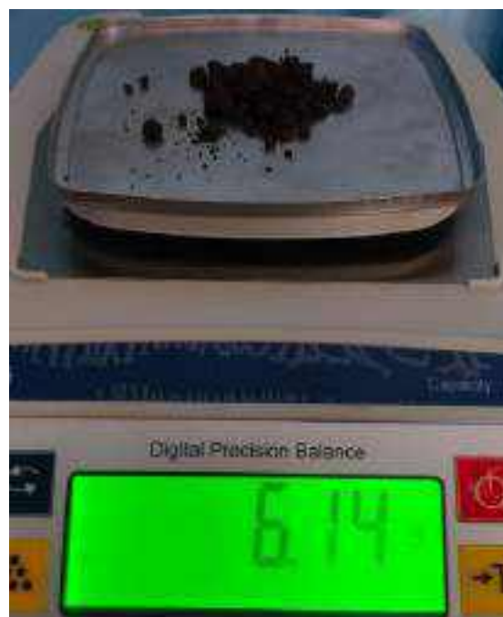
Gambar 4. Total scale pada tubing perforate
