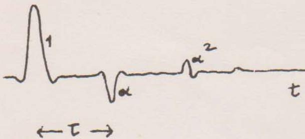
Dalam 'time section' ini akan merupakan pengganggu dan menyukarkan kita mengenal horizon atau marker yang sebenarnya. Apalagi untuk laut dangkal, dimana ' $\tau$ ' makin pendek, sehingga reverberasi ini berbentuk sinusoidal.
