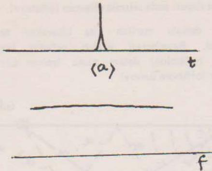
Sebagian dari frekwensi sinyal ini di serap oleh lapisan-lapisan tanah; sehingga setelah beberapa saat melalui lapisan tanah sinyal kita berubah bentuk menjadi:
