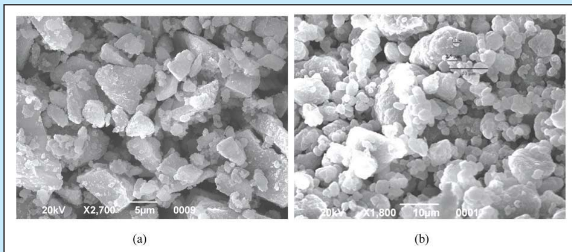
Gambar 5 Hasil SEM serbuk LiOH di milling selama satu jam (a) dan tiga jam (b)
