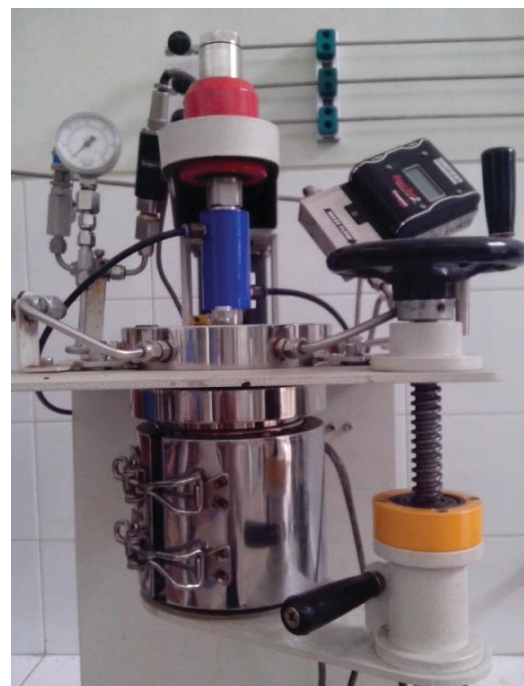
Gambar 2 Autoclave Reactor untuk Proses Kristalisasi Katalis.
